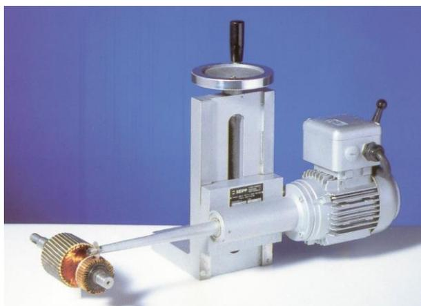
Scies électriques pour fraiser l'isolant des collecteurs
