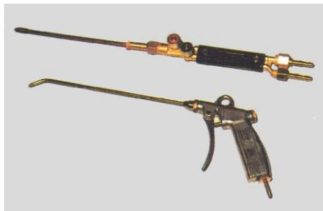
Appareil à brûler les résidus d'isolation dans les encoches
