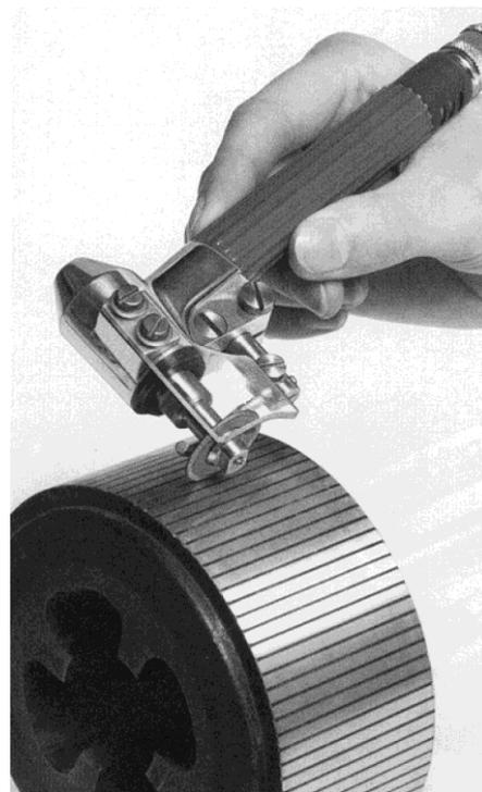
Scie pneumatique pour fraiser l'isolant des collecteurs
