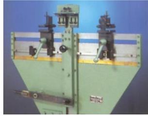
Dispositifs enrouleur et arracheur
