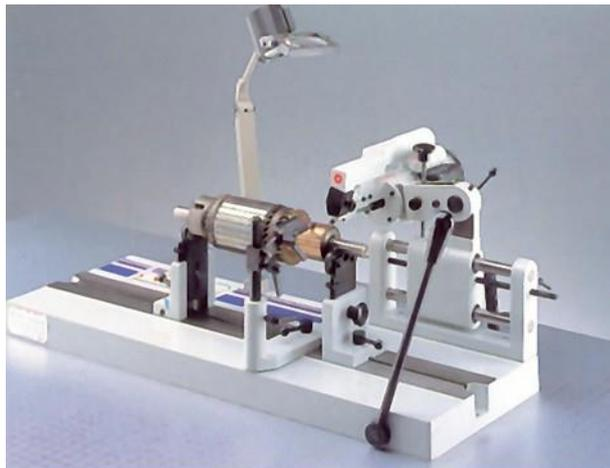
Scies électriques pour fraiser l'isolant des collecteurs
