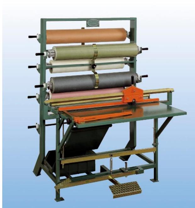
Dérouleuse / coupeuse pour des isolants souples jusqu'à 1050 mm
