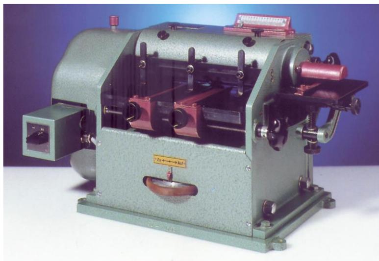
Machine pour plier et pour border les isolants d'encoche
