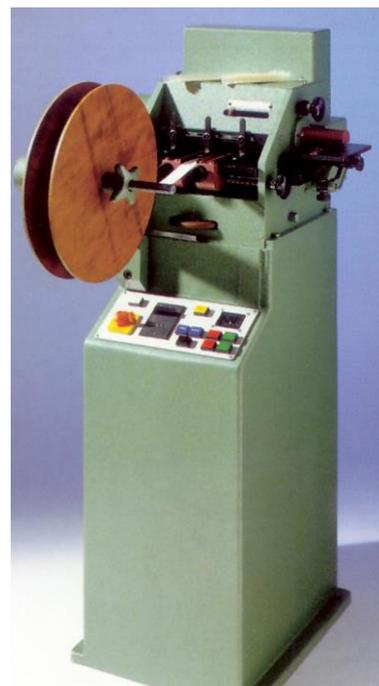
Machine pour plier et pour border les isolants d'encoche
